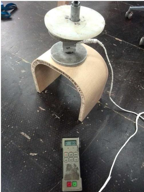
Figura 29- Ensayo de carga estática sobre el taburete
