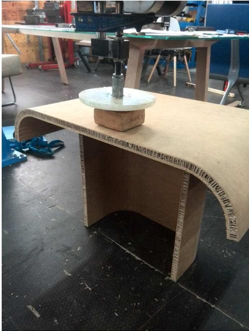
Tras la finalización del ensayo no se observan desperfectos ni roturas en los componentes de la mesa ni pérdida de servicio.
