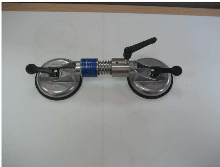
Figura 19 – Unión de placas de 200 mm con un solo dispositivo
