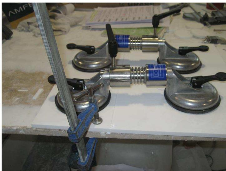
Figura 21 – Montaje utilizado para mantener las superficies planas en caso de espesores de 9 mm
