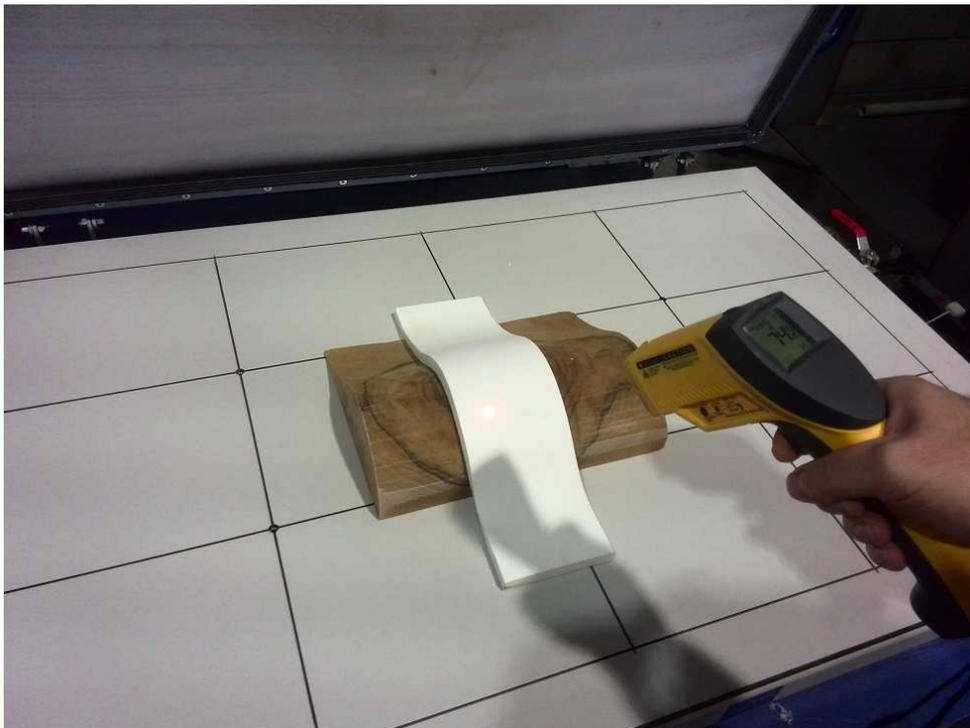
Figura 17- Medición de la temperatura superficial de la pieza curvada
