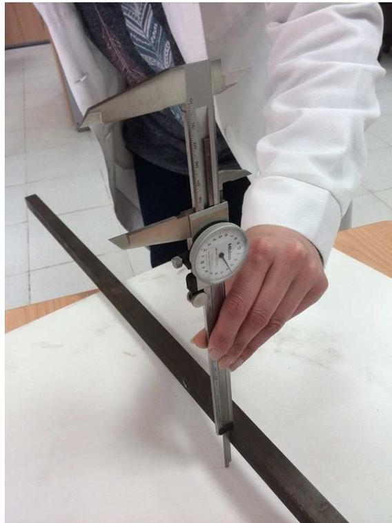
Figura 2- Medición de la deformación máxima conseguida con molde semiesférico
