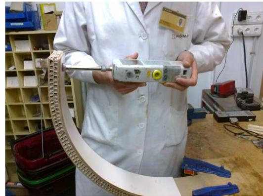
Figura 26- Montaje con dinamómetro y empujador
