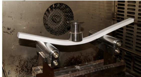
Figura 9 – Probeta flexionada bajo carga
