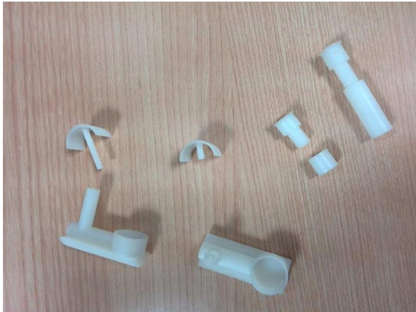
Figura 31- Prototipos de los herrajes construidos mediante impresión 3D
