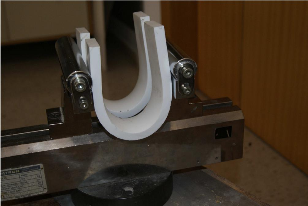
Figura 11 – Deformación del solid tras calentamiento a 200°C
