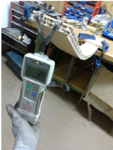
Figura 25- Montaje con dinamómetro y gancho
