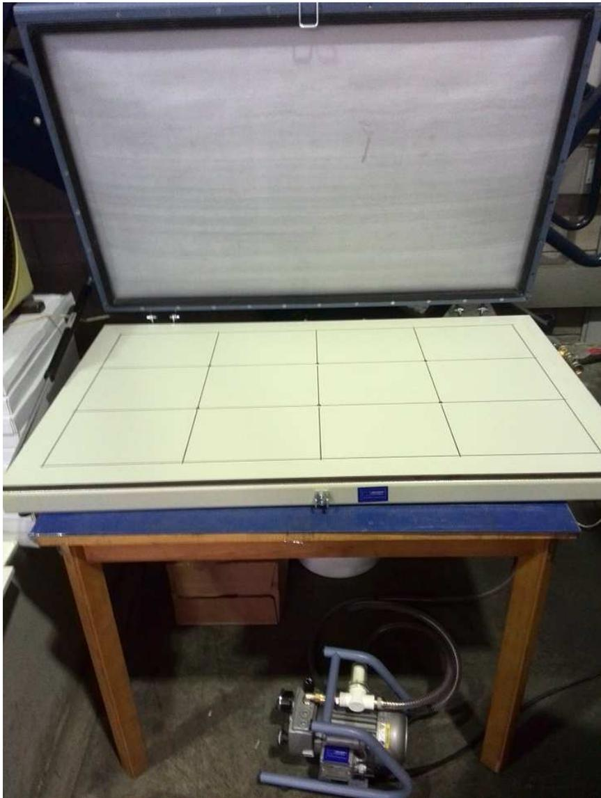
Figura 15- Prototipo de prensa de membrana de sobremesa con bomba de vacío
