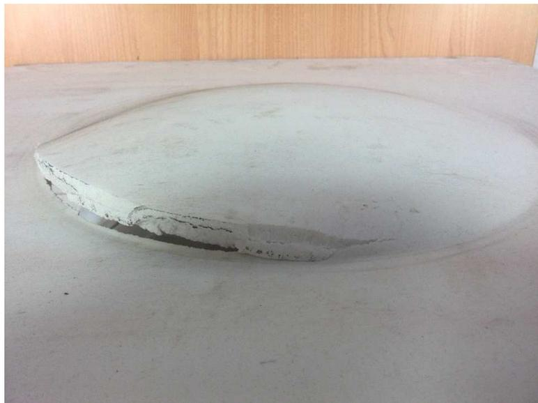
Figura 3- Rotura del material al alcanzar la deformación máxima
