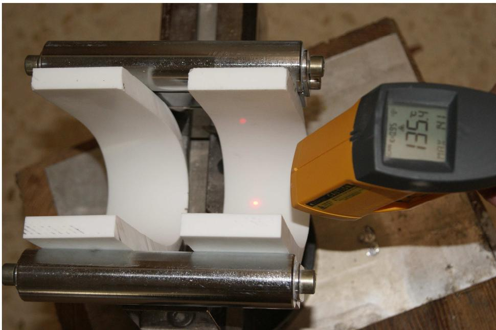
Figura 12 – Medición de la temperatura superficial
