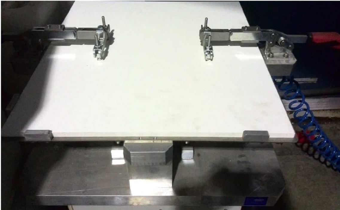
Figura 1- Pieza de solid en el molde antes de aplicar vacío
